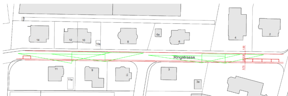
Abbildung 43: Schematische Darstellung Variante 2 - Längsparkierung südliche Strassenseite
